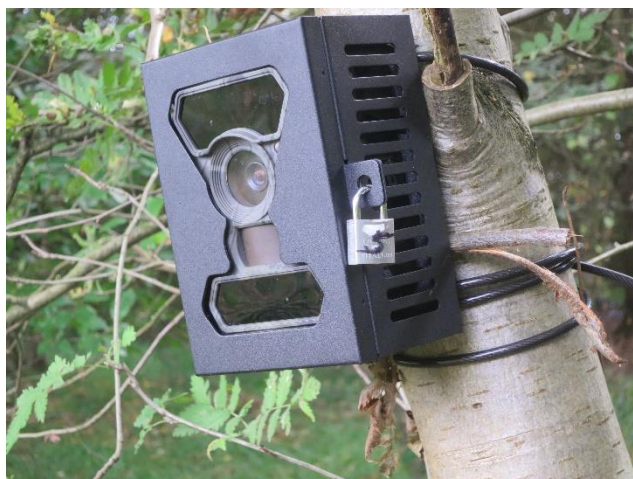
Abb. 5: Wildtierkamera im Gehäuse mit Schloss gesichert
